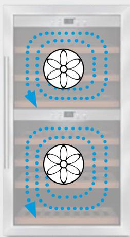
Die aktive Lüftung sorgt in jeder Temperaturzone für eine Luftzirkulation, die eine gleichmäßige Temperatur erzeugt. So entsteht in Wechselwirkung mit der Wärme des Kompressors und den Luftströmen eine ideale Luftfeuchtigkeit.
