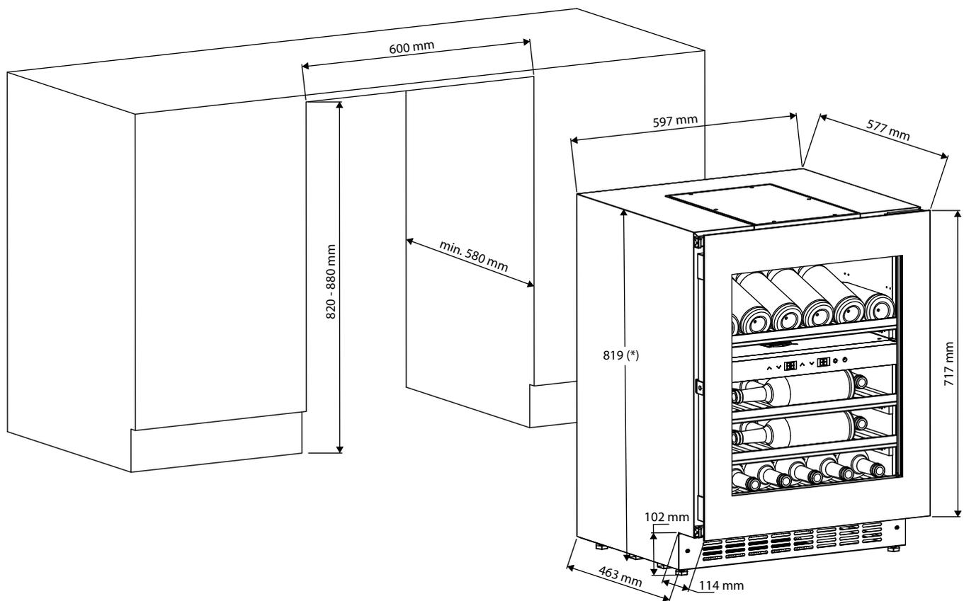
\* Die Einbauhöhe kann durch die verstellbaren Füße bis zu 899 mm erhöht werden.
