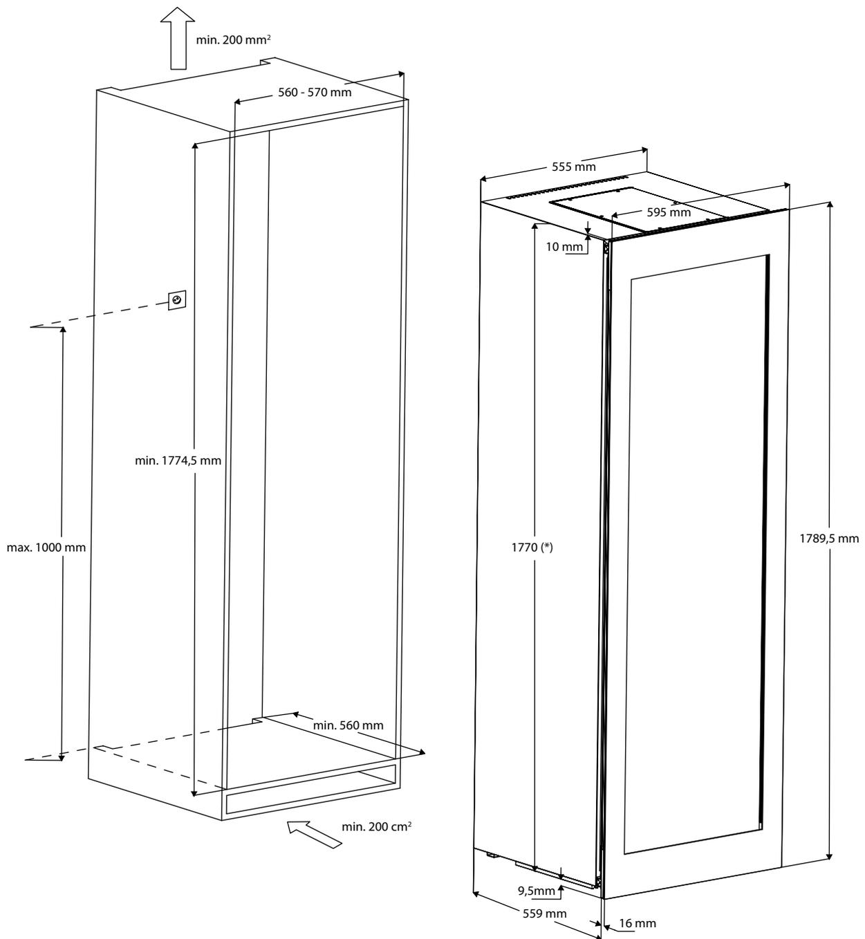
\* Die Einbauhöhe kann durch die verstellbaren FüÙe bis zu **1785 mm** erhóht werden.
