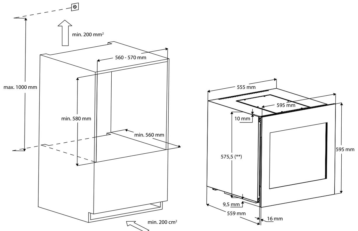
\* Die Einbauhöhe kann durch die verstellbaren Füße bis zu 455,5 mm erhöht werden.
