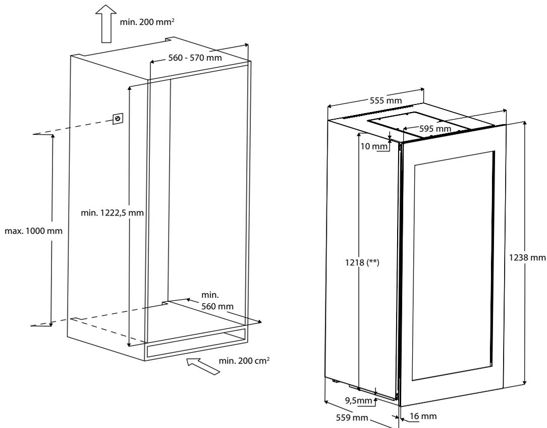
\* Die Einbauhöhe kann durch die verstellbaren Füße bis zu 887 mm erhöht werden.
