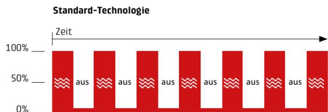
Leistungssteuerung durch Intervalle mit Standard-Mikrowellentechnologie. Beispiel: 50 % Leistung (ca. 450 Watt)
