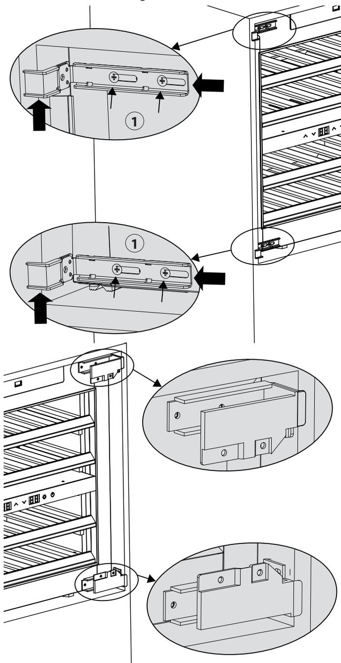
9. Fäst enheten med de medlevererade skruvarna genom distanshållarna och fästvinklarna på möbelkroppen.
