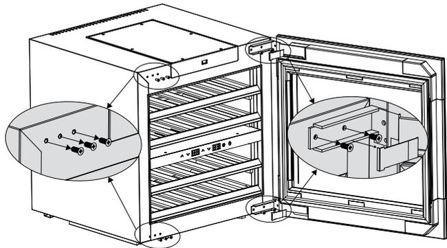
4. Снимите дверцу и поверните ее на 180°.
