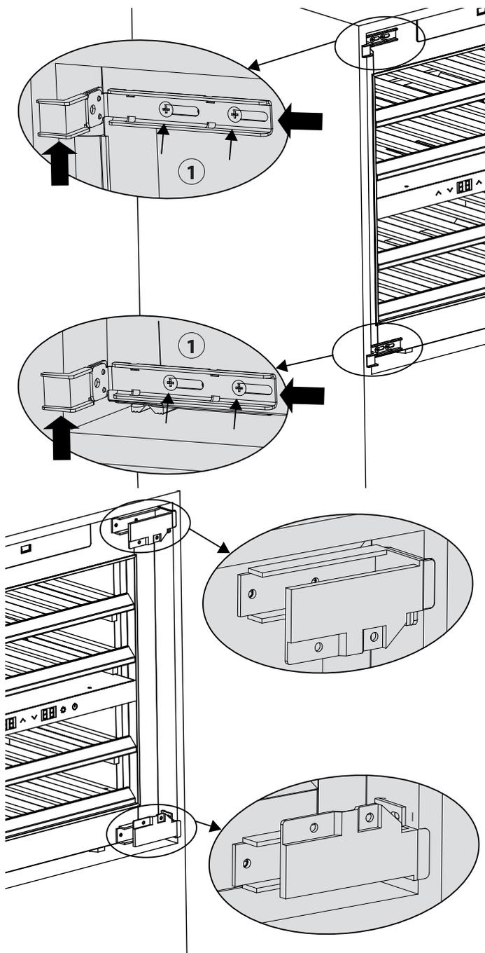
9. Fixe o aparelho ao corpo do móvel com os parafusos fornecidos através dos distanciadores e dos suportes angulares.
