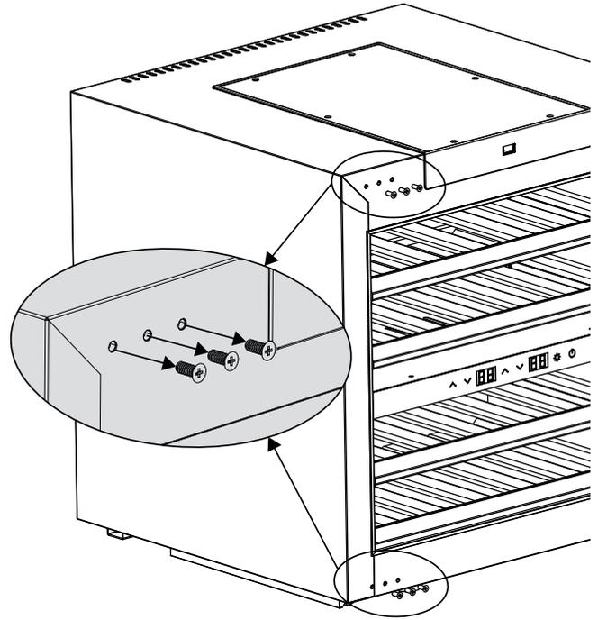
7. Coloque os distanciadores nos suportes angulares e aparafuse-os uns aos outros. Conforme o batente da porta, mude correspondentemente a posição.
