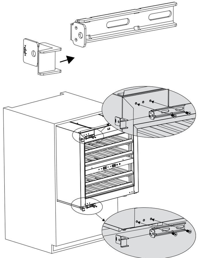
8. Skjut nu in enheten komplett i vrån. Kontrollera avstånden runt omkring enheten. Distanshållarna hjälper dig att positionera enheten i en plan linje framtill i vrån. Lossa skruvarna (1), skjut distanshållarna mot möbelväggen och skruva fast skruvarna igen.
