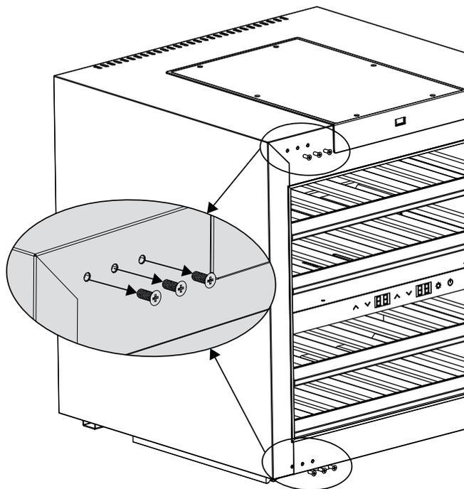
7. Вставьте фиксаторы на уголки крепления и соедините их винтами. Положение отличается в зависимости от ограничителя дверцы.
