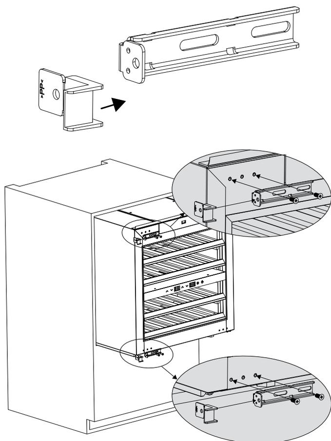
8. Полностью задвиньте устройство в нишу. Проверьте расстояния вокруг. Подкладки позволяют разместить устройство заподлицо в нише. Ослабьте винты (1), переместите фиксаторы к стене мебели и снова закрепите винты.
