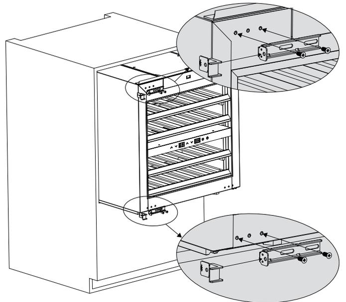
8. Insira completamente o aparelho no nicho com cuidado. Verifique as distâncias a toda a volta. Os distanciadores ajudam a posicionar o aparelho alinhado com a frente do nicho. Desaperte os parafusos (1), mova os distanciadores para a parede do móvel e aperte novamente os parafusos.
