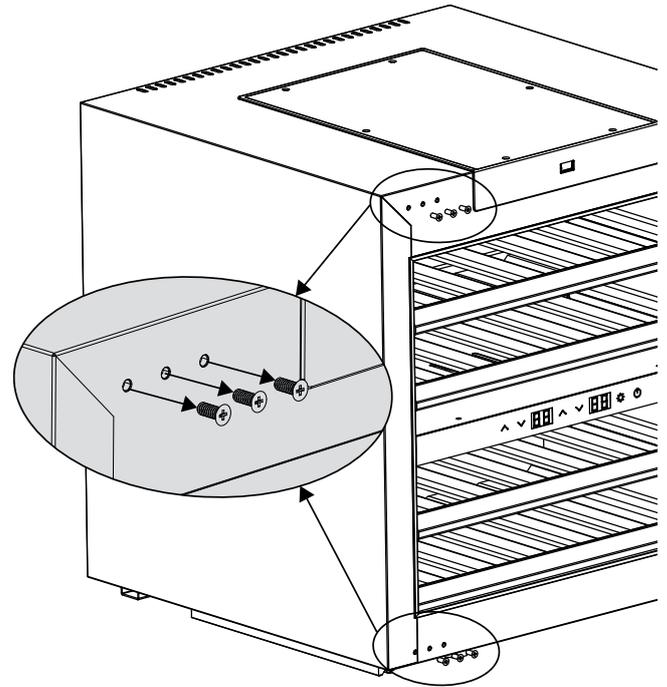
7. Placera distanshållarna på fästvinklarna och skruva på dem tillsammans. Alltefter dörrestopp motsvarande annan position.
