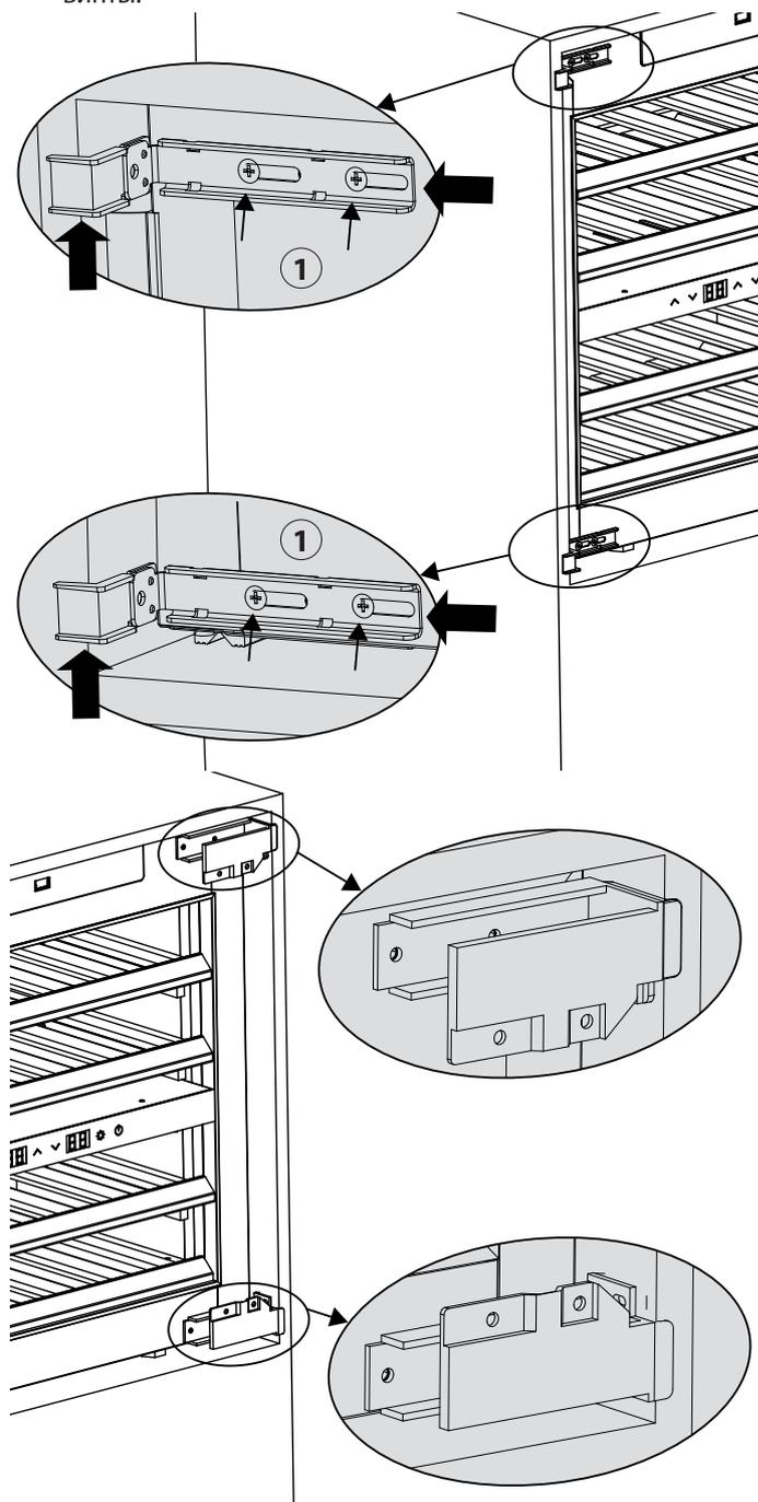
9. Закрепите устройство винтами (из комплекта поставки) на корпусе мебели, вставив их в фиксаторы и уголки крепления.
